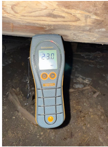
Krypkjeller er trang inn mot sørvest side. Høy fuktighet i treverk.
