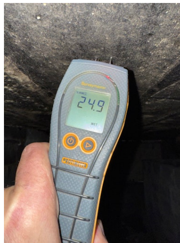
Krypkjeller er trang inn mot sørvest side. Høy fuktighet i treverk.
